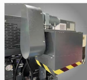
▶ Vynašeč třísek ▶ Namontován na zadní straně
