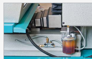
Centrální rozvod mazání
