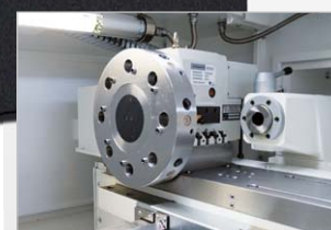
▶ Hydraulický výměník nástrojů VDI30 pro osm nástrojů
