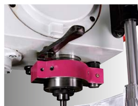
Vyražeč usnadňuje výměnu nástrojů
