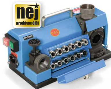
GS-1 – bruska na spirálové vrtáky pravé ø 2 – 13 mm , úhel broušení 90 – 135°. S adaptérem a dodatečnou sadou kleštin (volitelné příslušenství) možno brousit vrtáky až do ø 16 mm.
