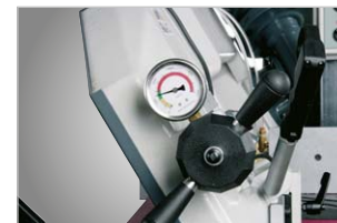
▶ Přesné mechanické napínání pásu pomocí manometru.
