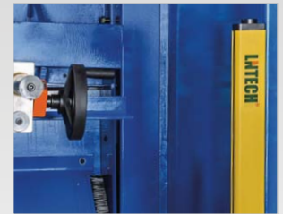
Optická čidla zabezpečují zadní prostor stroje.
