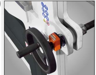
▶ Nastavení zadního dorazu pomocí ručního kola
