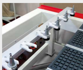
► Lineární zásobník na 6 nástrojů,
