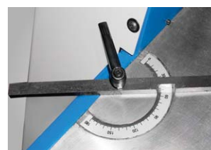
Nastavitelný úhlový doraz s milimetrovou stupnicí
