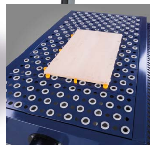
▶ Stavitelné dorazy pro zajištění obrobku
